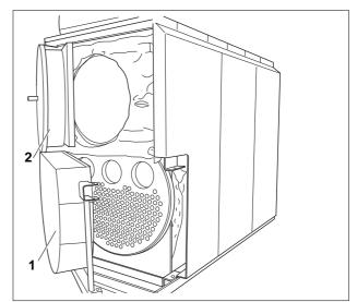
Fig. 29 Open the boiler door
