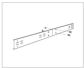
Fig. 11 Longitudinal (L-)bracket
